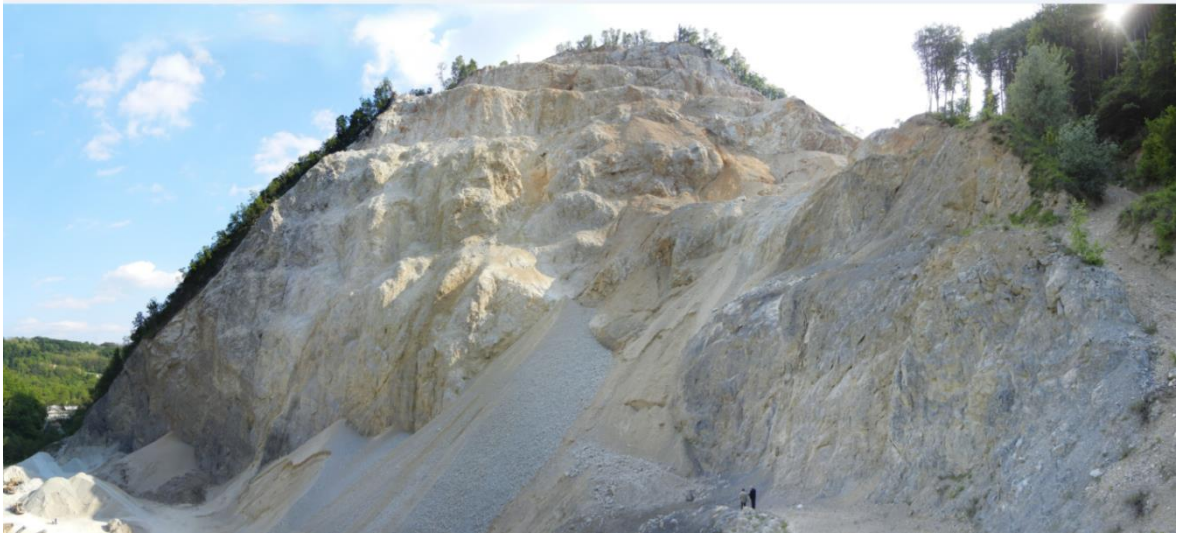
Pogled odozdo na visinski dio kopa - etaže
